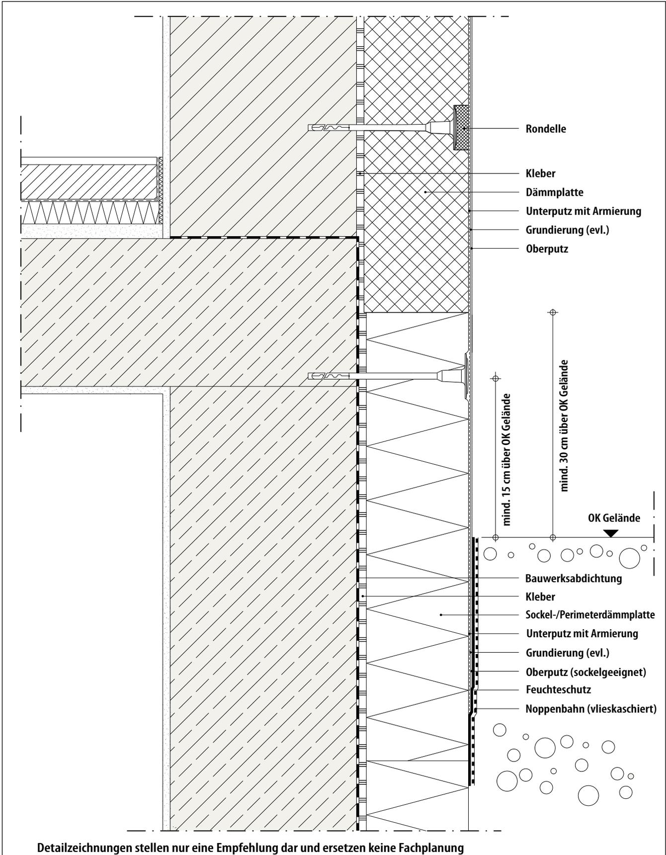
**Sockel flächenbündig, geringe Einbindung ins Erdreich**
