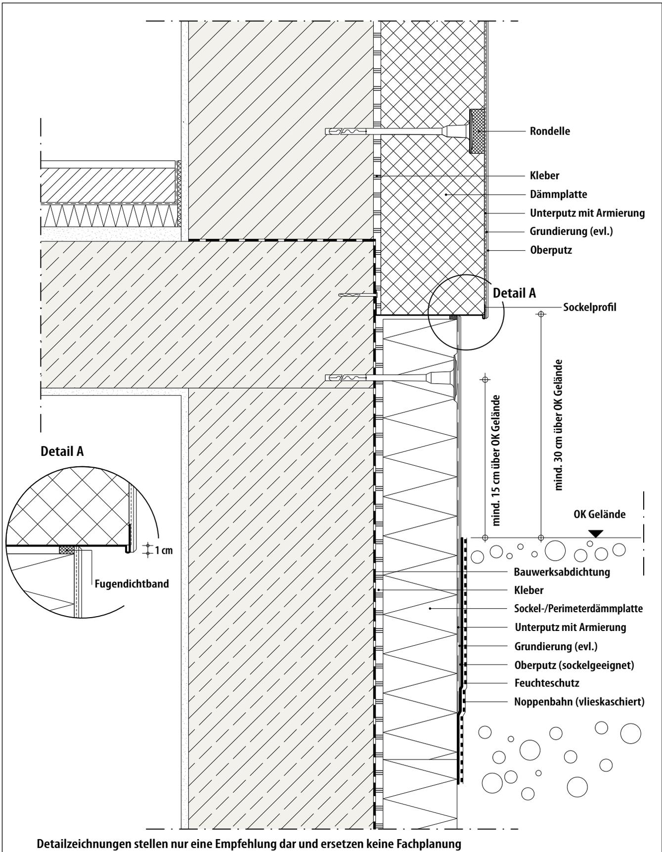
**Sockel rückspringend, Anschluss an Perimeterdämmung**
